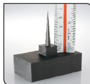
石墨電極 使用刀具:10mm平刀 加工時間:85min
