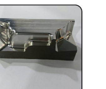
加工材質: SKD61 刀具:Φ6R3 圓鼻刀 Φ4R2 球刀 加工時間:132min
