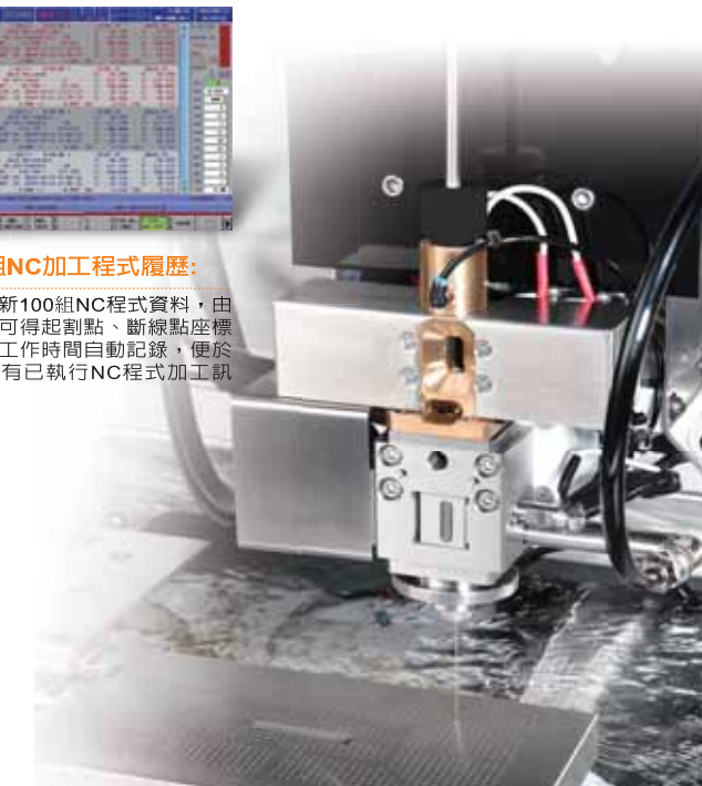
多孔穿線測試實況
